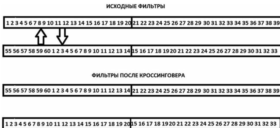
Рис. 1. Схема "кроссинговера" фильтров. Числа в рамках — порядковые номера отсчетов в каждом из фильтров
