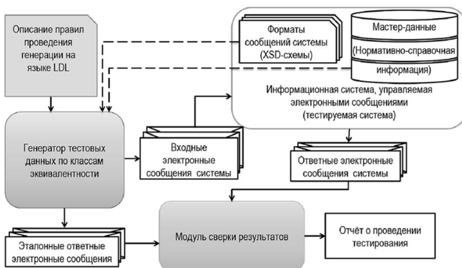
Рис. 4. Проведение тестирования с применением инструмента генерации тестовых данных
