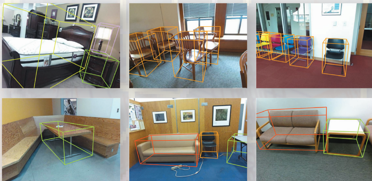
Рис. 3. Объекты, обнаруженные с помощью предложенного метода на монокулярных изображениях из валидационной части набора данных SUN RGB-D
