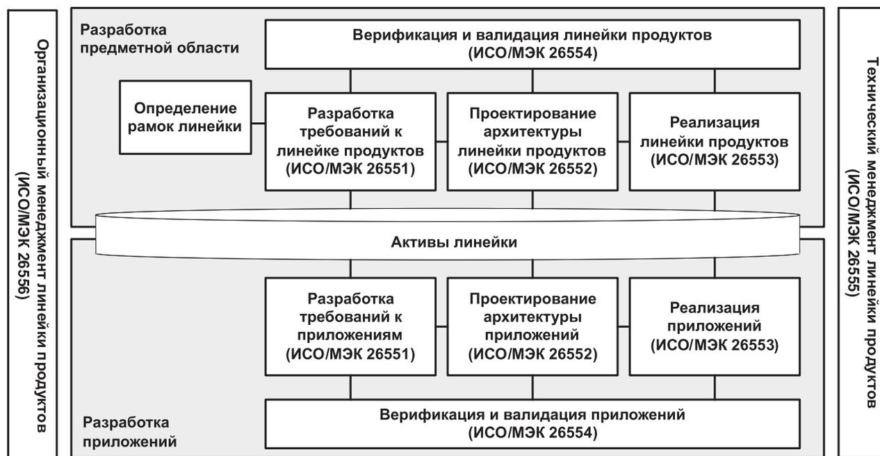
Рис. 2. Эталонная модель линеек программных продуктов и систем согласно ISO/IEC 26550:2015 [15]
