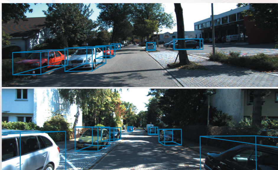
Рис. 3. Объекты, обнаруженные с помощью предложенного метода по изображениям из валидационной части набора данных KITTI
