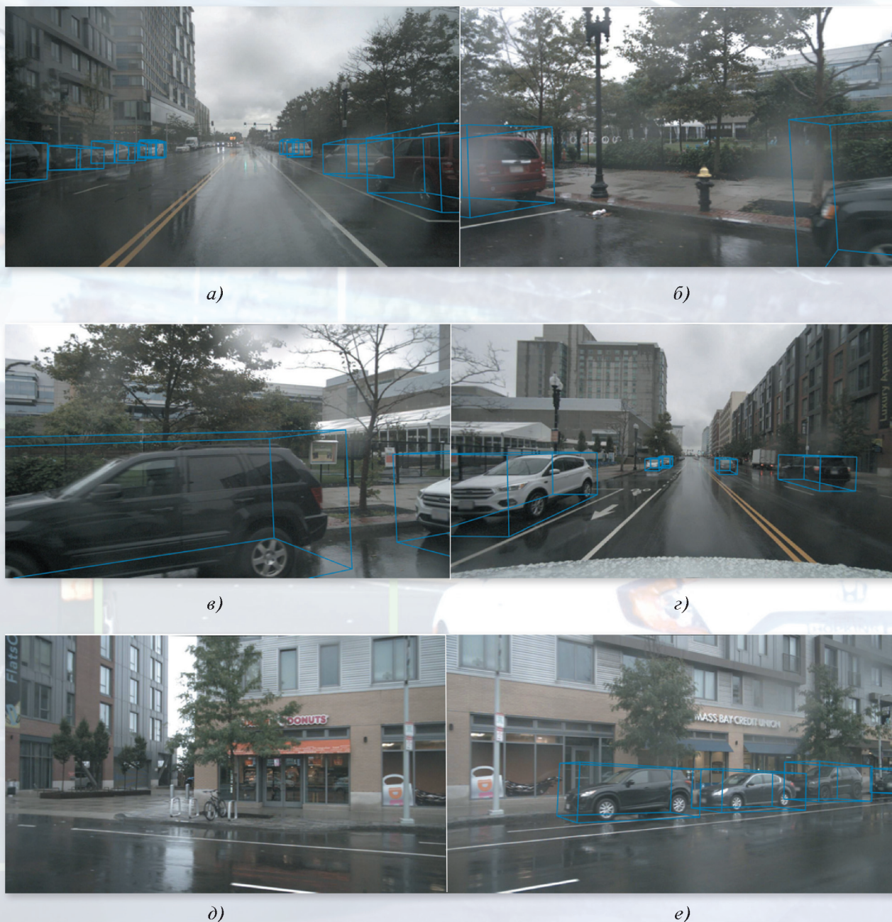
Рис. 4. Объекты, обнаруженные с помощью предложенного метода по мультиракурсному входу с шести камер из валидационной части набора данных nuScenes.
