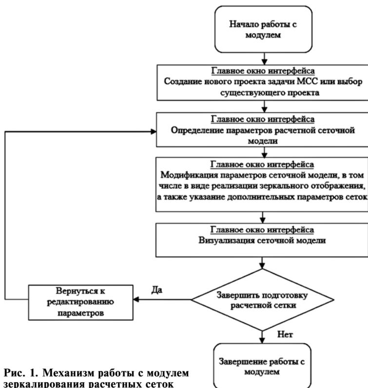
Рис. 1. Механизм работы с модулем зеркалирования расчетных сеток
