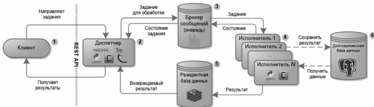
Рис. 1. Предлагаемая архитектура распределенной вычислительной системы
