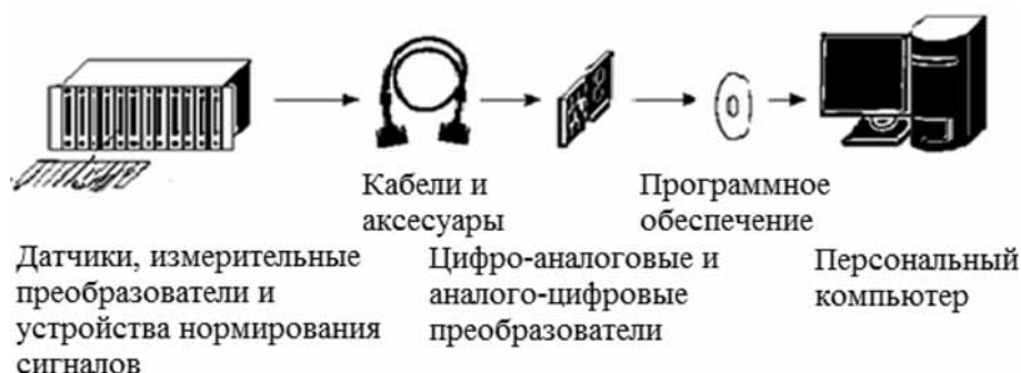
Рис. 3. Общая схема формирования контрольно-измерительной системы
