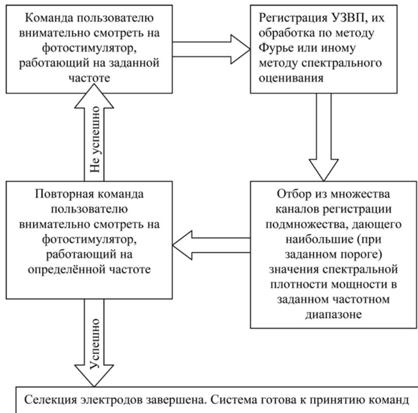
Рис. 3. Схема процесса селекции электродов для оптимизации работы НКИ на основе УЗВП
