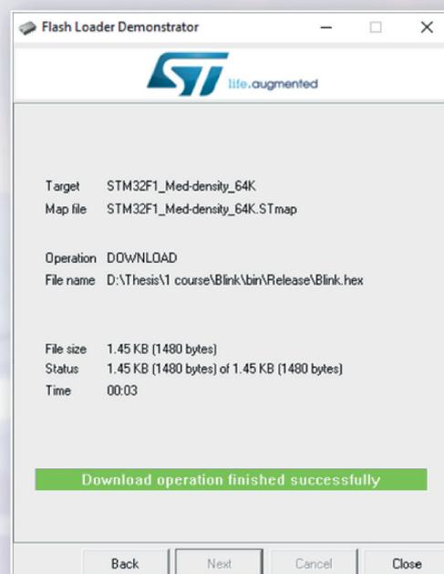
Рис. 17. Удачное завершение процесса программирования микроконтроллера
