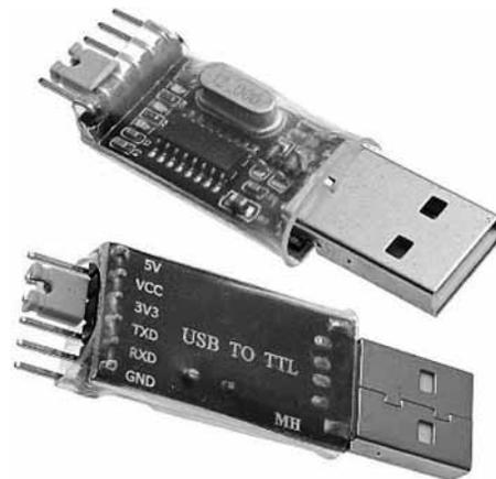
Рис. 4. Преобразователь USB to RS-232\_TTL на микросхеме CH340G
