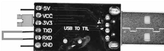
Рис. 8. Схема подключения для тестирования адаптера
