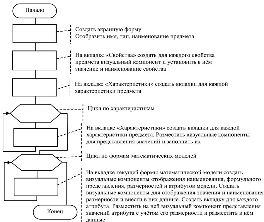
**Рис. 1.** Блок-схема алгоритма генерации экранной формы пользовательского интерфейса представления данных на основе декларативного описания на языке ИНСТРУМЕНТ-П
