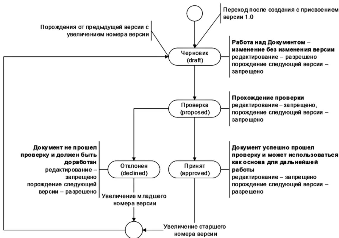
Рис. 3. Пример изменения атрибута конструкторского документа в процессе разработки КД
