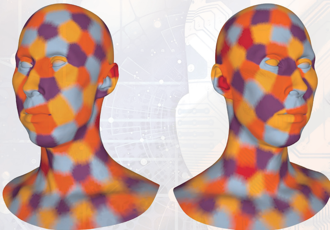
Рис. 2. Пример разбиения геометрии на патчи
