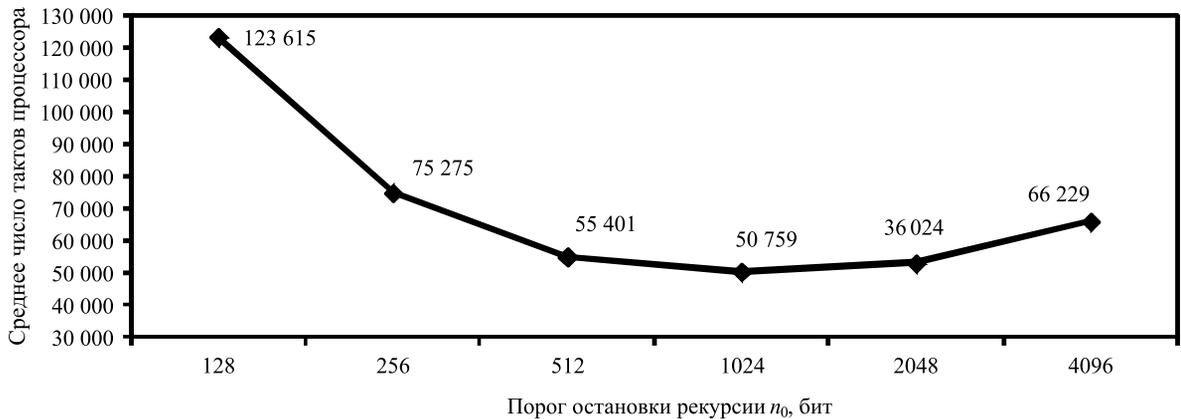
Рис. 4. Среднее число тактов процессора при вычислении произведения целых чисел разрядности 8192 бит при  $w = 64$  бит для различных значений порога остановки рекурсии  $n_0$  по алгоритму 2 (SKML)
