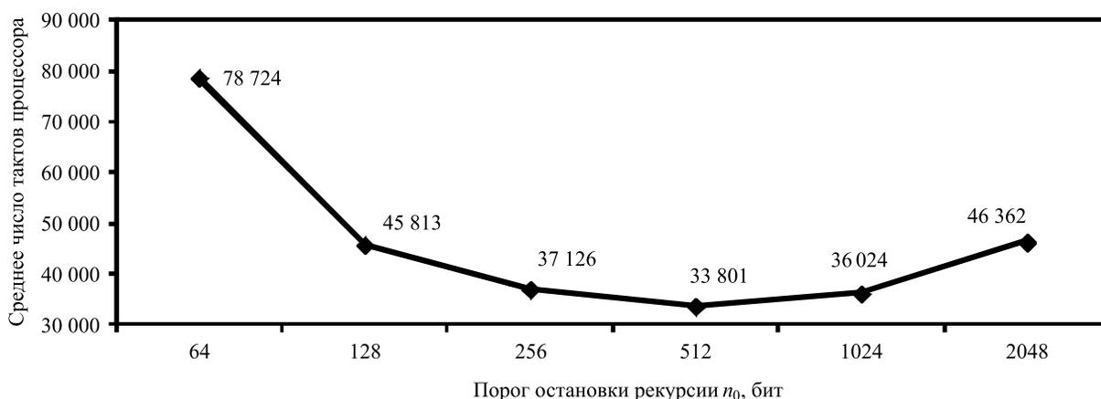
Рис. 3. Среднее число тактов процессора при вычислении произведения целых чисел разрядности 4096 бит при  $w = 32$  бит для различных значений порога остановки рекурсии  $n_0$  по алгоритму 2 (SKML)
