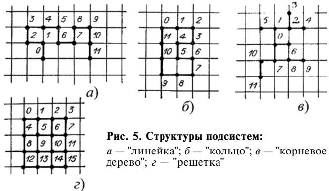
Рис. 5. Структуры подсистем: а — "линейка"; б — "кольцо"; в — "корневое дерево"; г — "решетка"
