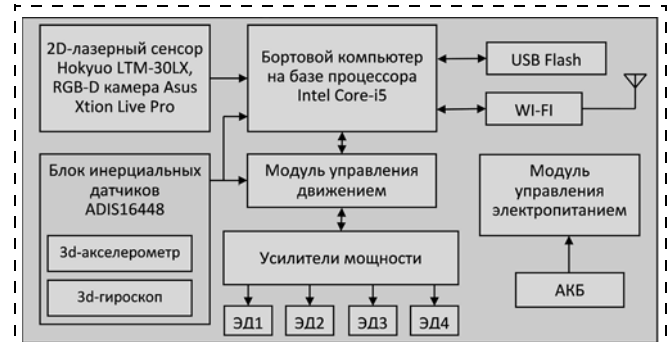
Рис. 9. Функциональная схема автономной системы управления БПЛА
