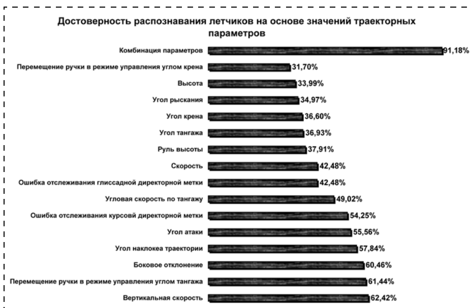
Рис. 1. Достоверность идентификации летчиков на основе значений траекторных параметров
