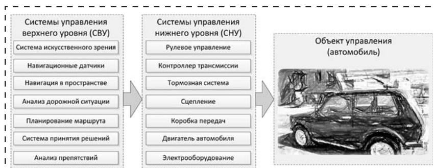
Рис. 1. Пример структуры автономно управляемого автомобиля
