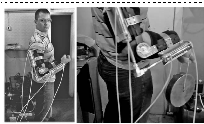
Рис. 4. Модуль локтевого сустава и поднятие груза оператором
