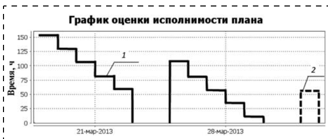
Рис. 10. Динамика времени опережения и запаздывания для потока в 41 заказ в зависимости от модельного времени: 1 — динамика среднего времени опережения на единицу продукта; 2 — динамика среднего времени опоздания на единицу продукта
