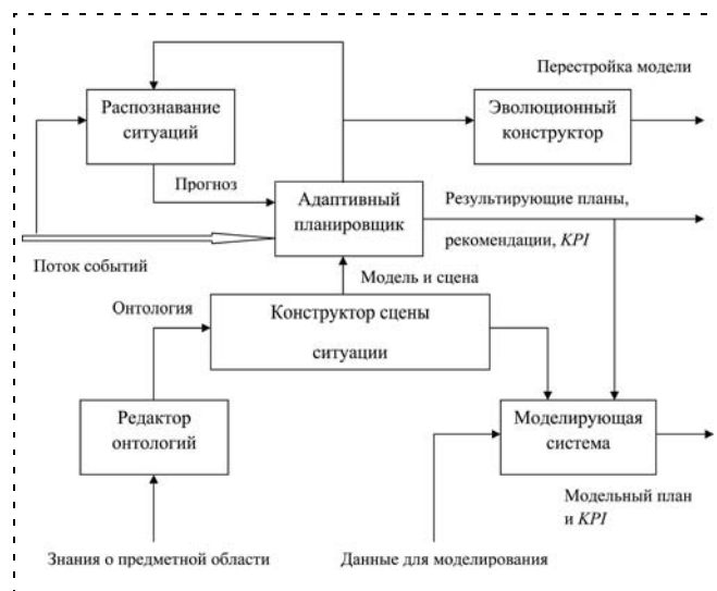
Рис. 1. Архитектура базовой системы адаптивного планирования
