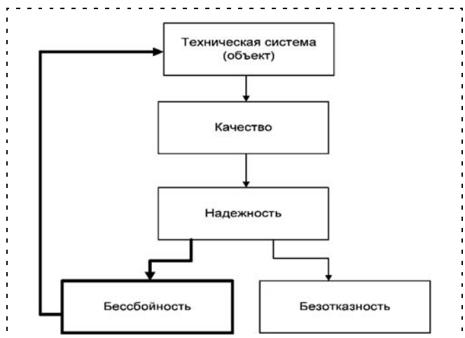
Рис. 2. Новое свойство технических систем — бессбойность — и связь бессбойности с существующей структурой диагностики объектов (толстые линии)
