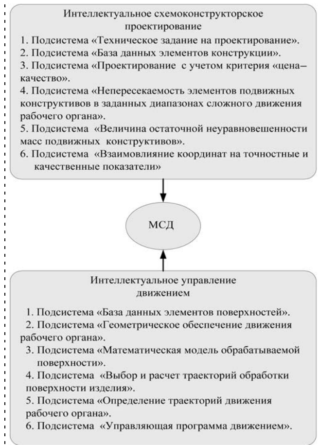
Схема интеллектуальных компьютерных компонентов конкретного изделия
