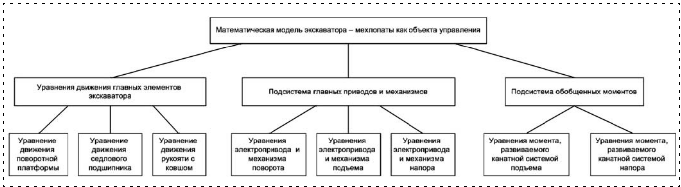
Рис. 1. Структура математической модели экскаватора
