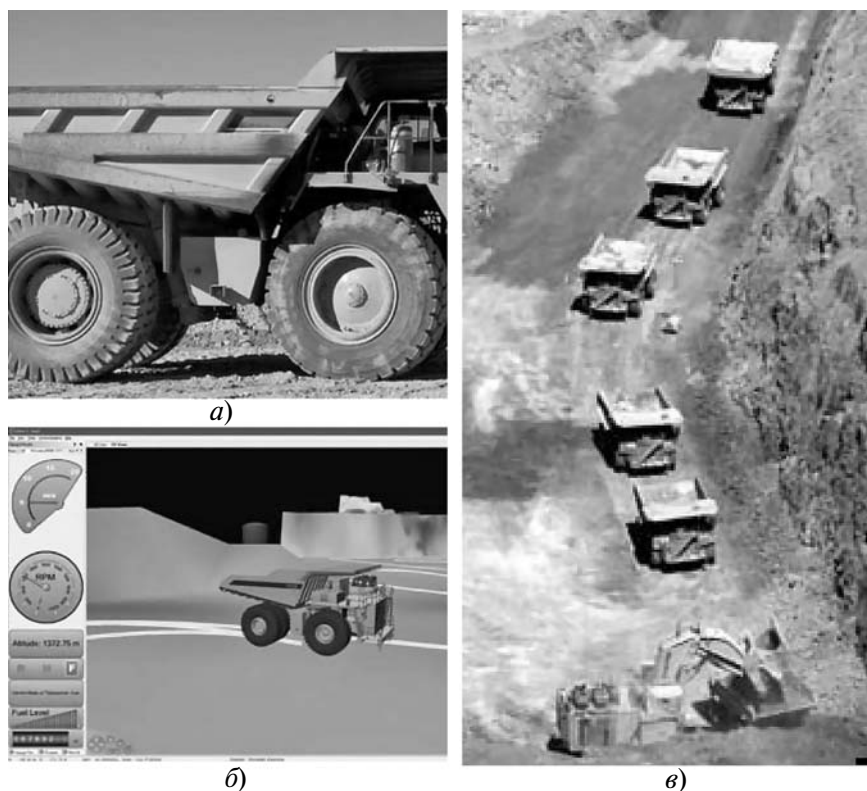
Рис. 9. Использование комплекса программно-инструментальных средств "Mobius" ( Autonomous Solutions Inc., USA ) для планирования движения группы автономных мобильных платформ на базе карьерного самосвала в режиме следования за ведущим: автономная мобильная платформа на базе карьерного самосвала (а); планирование автономного движения "ведущего" (б); обработка сформированного задания (в)
