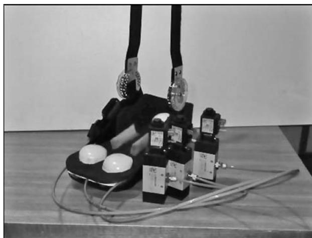
**Рис. 9. Пневматические прессовые эффекторы стопы и пневмоклапаны управления ими**
