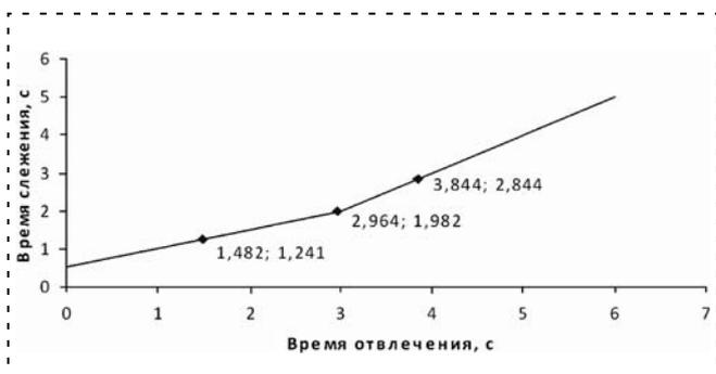
Рис. 10. Кусочно-линейная аппроксимация экспериментальной зависимости времени слежения от времени отвращения
