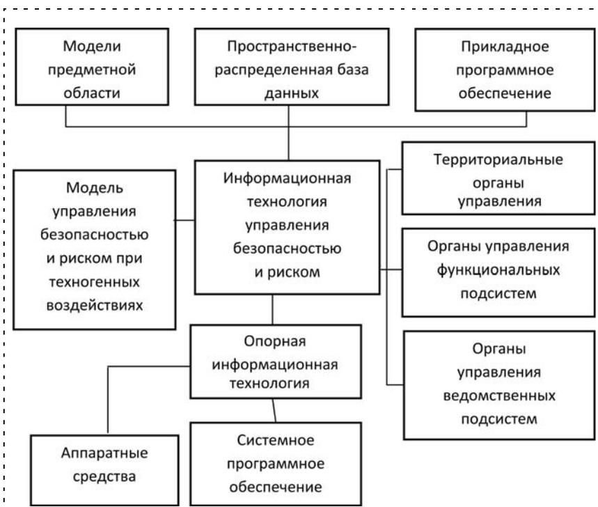
Рис. 3. Схема формирования информационной технологии управления безопасностью и риском при техногенных воздействиях
