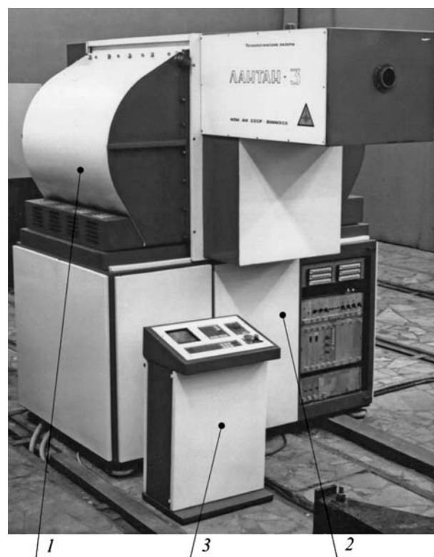
Рис. 1. Лазер с несамостоятельным тлеющим разрядом: 1 — газовый контур; 2 — системный блок; 3 — микропроцессорное устройство управления
