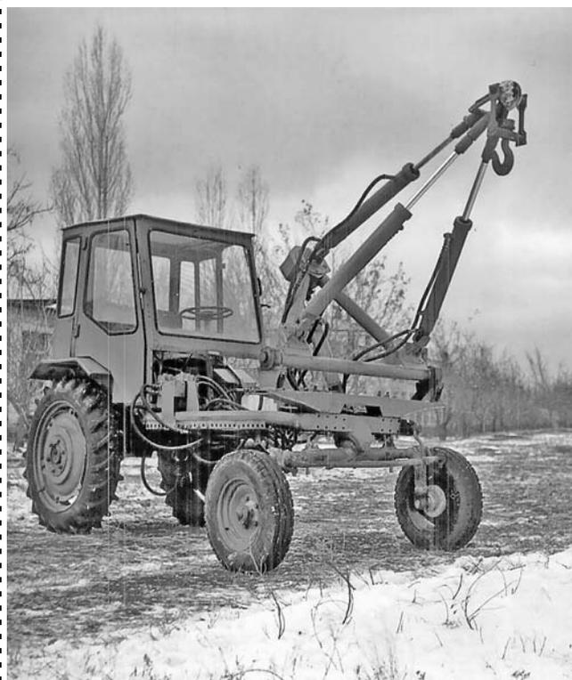
**Рис. 1.** Манипулятор на основе пространственного механизма в виде трипода на самоходном колесном шасси
