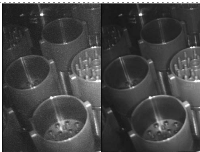
Рис. 1. Сложение множества кадров, улучшение показателя сигнал/шум
