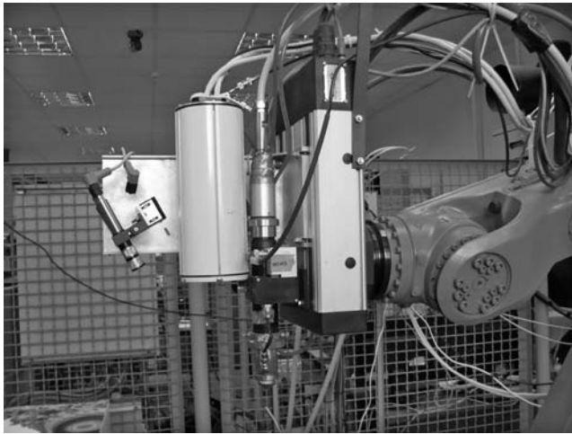
Рис. 5. САУ с лазерной головкой, смонтированная на фланце робота
