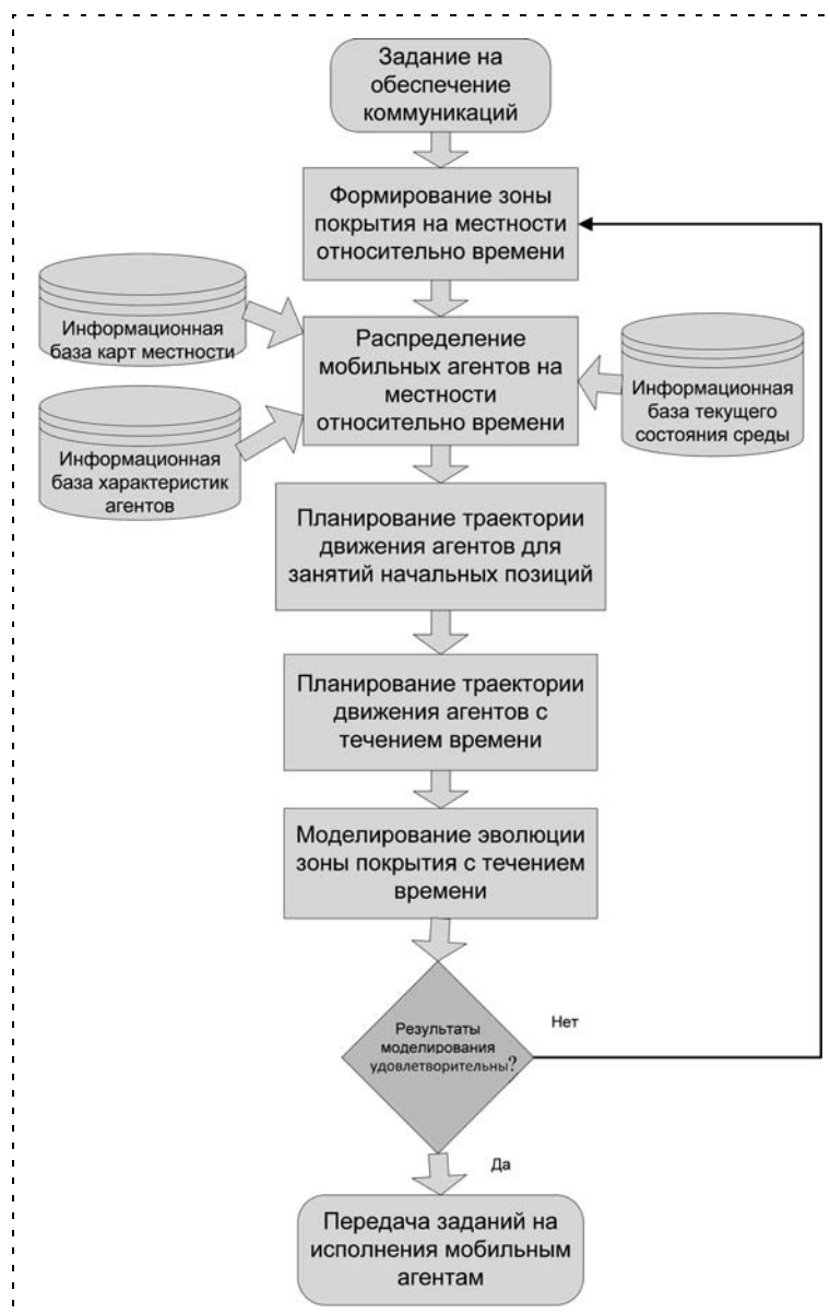
Рис. 3. Технология создания подвижных реконфигурируемых коммуникационных сетей на базе автономных мобильных мехатронных агентов
