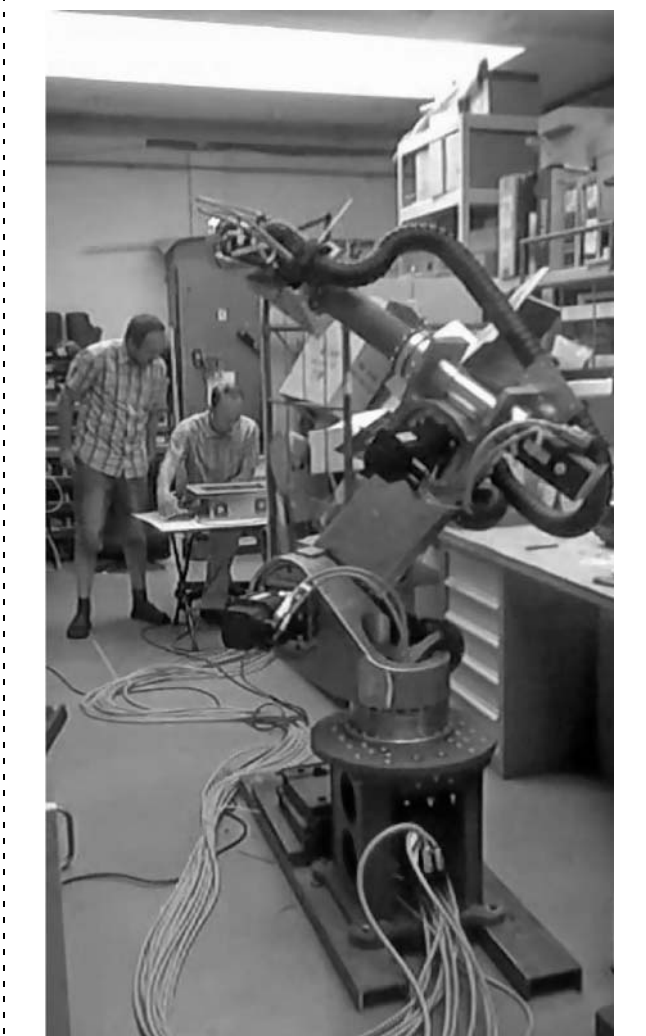
Рис. 4. Манипулятор, разработанный в рамках НИОКР "Лазерсварка"
