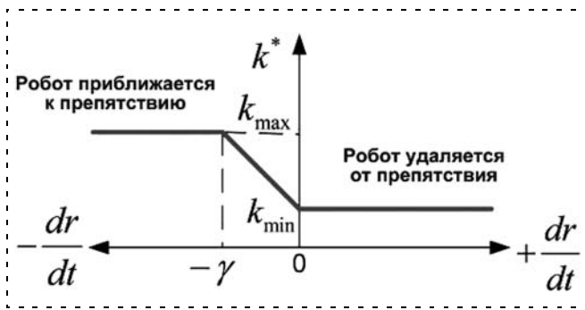
Рис. 2. Коэффициент обратной связи зависит от производной расстояния r
