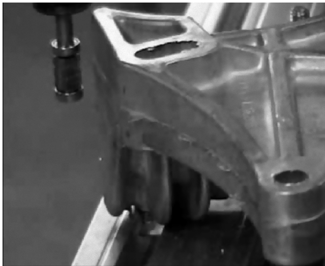
Рис. 2. Схема рабочего процесса при снятии фрезой заусенцев с боковой поверхности заготовки
