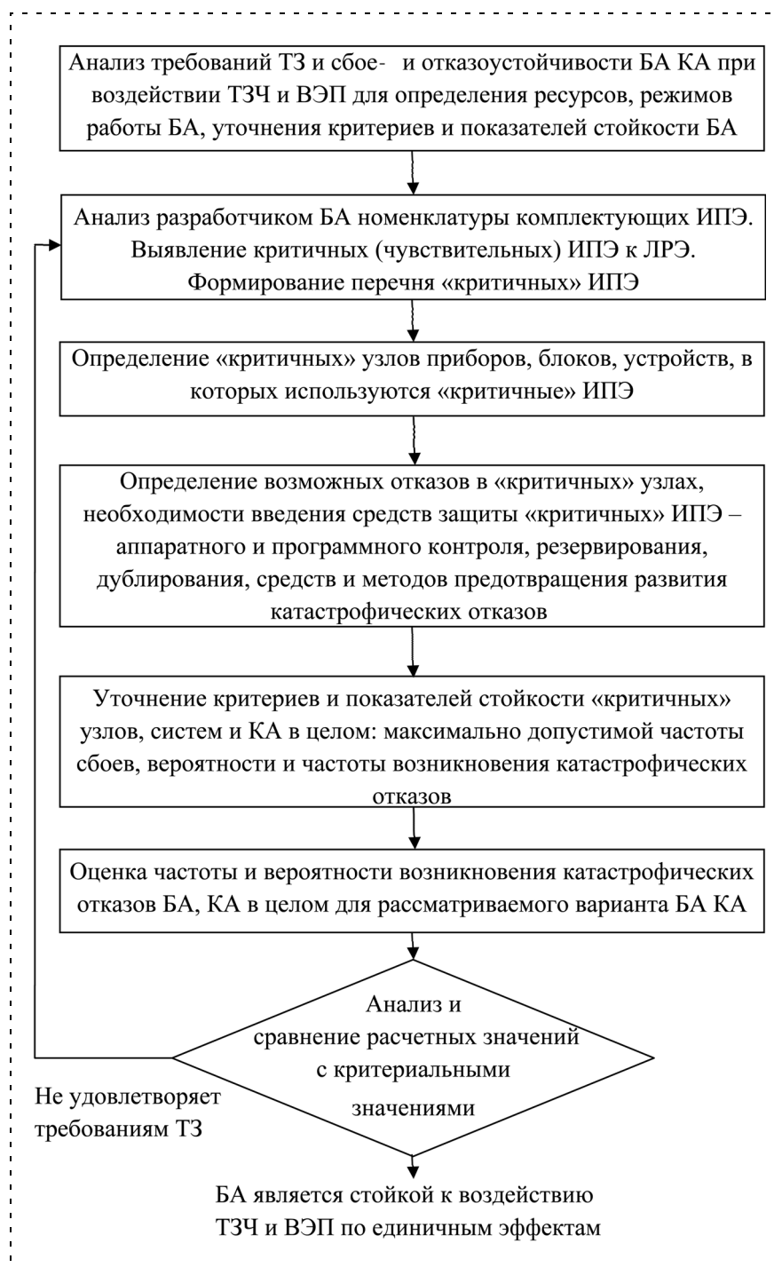
Рис. 7. Алгоритм оценки и обеспечения сбое- и отказоустойчивости БА КА от воздействия ТЗЧ и ВЭП на этапах разработки БА (ИПЭ — изделия полупроводниковой электроники)
