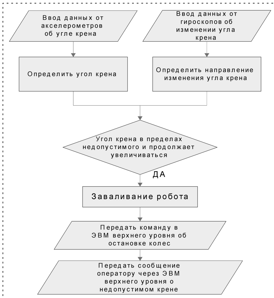
Рис. 7. Блок-схема фрагмента комплексирования данных, поступающих от акселерометров и гироскопов
