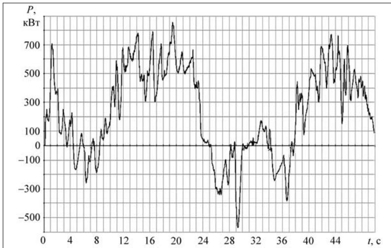
Рис. 4. Диаграмма активной мощности, потребляемой экскаватором
