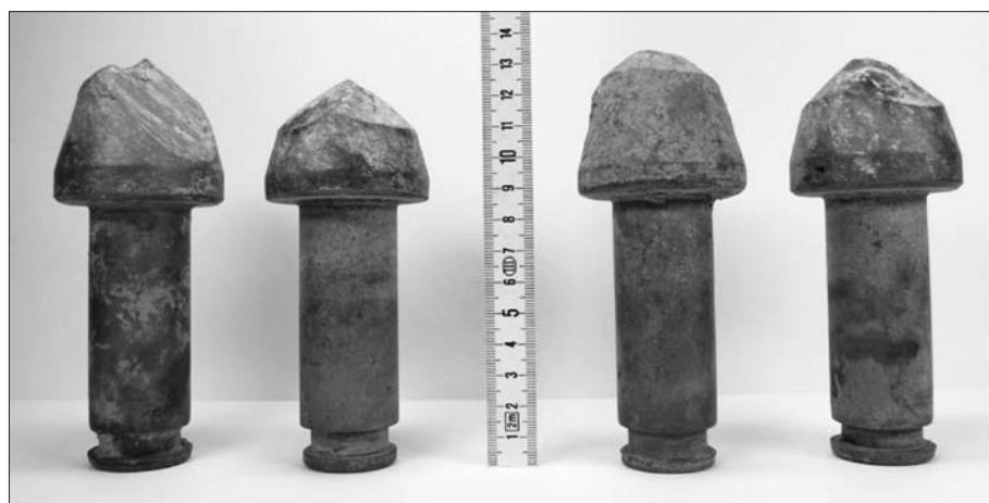
Износ резцов PSH33-85/17,5 после разрушения керна
