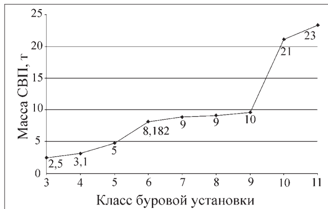
Рис. 2. Зависимость массы системы верхнего привода от класса буровой установки
