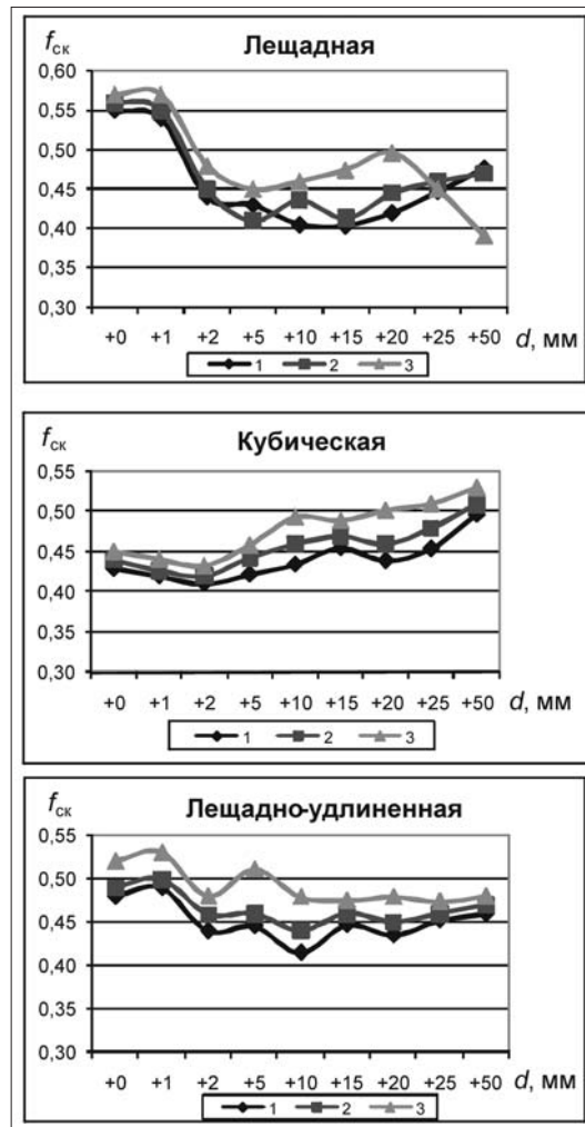
Рис. 2. Зависимость кинетического коэффициента трения f_{ск} по стали от крупности частиц d при их различной форме: 1 – уголь; 2 – средний показатель; 3 – порода
