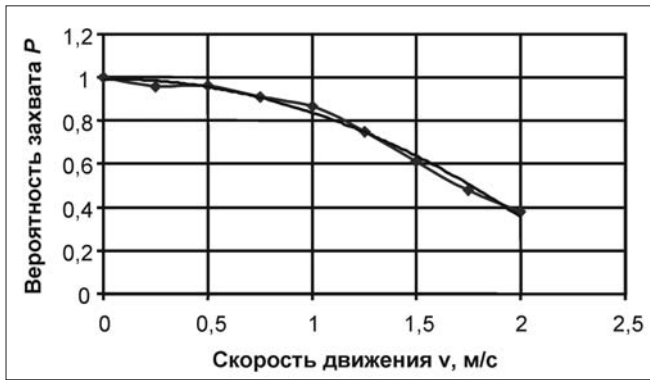
Рис. 1. График зависимости вероятности захвата железомарганцевых конкреций от скорости движения придонного добычного агрегата
