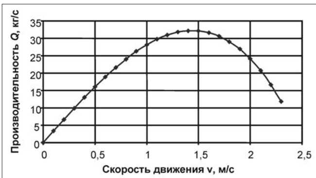
Рис. 2. График зависимости производительности добычного агрегата от скорости его перемещения с учетом падения вероятности захвата железомарганцевых конкреций
