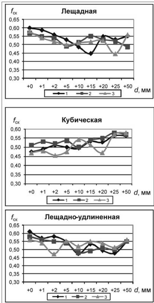
Рис. 1. Зависимость кинетического коэффициента трения f_{ск} по резине от крупности частиц d при их различной форме: 1 – уголь; 2 – средний показатель; 3 – порода
