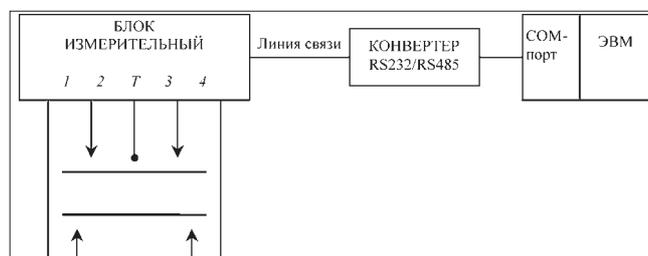
Рис. 1. Структурная схема автоматизированной установки контроля влажности:
