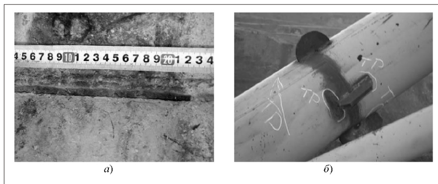
Рис. 2. Примеры контролируемых узлов, в которых были выявлены "ложные" зоны повышенной активности АЭ
