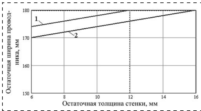
Рис. 5. Зависимости остаточной ширины проводника от остаточной толщины стенки: 1 — проводник сечением 180 \times 180 \times 12 мм; 2 — проводник сечением 180 \times 180 \times 16 мм
