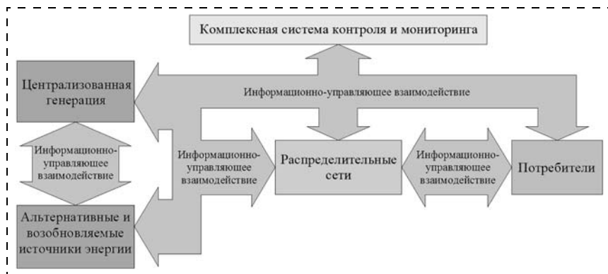
Рис. 1. Обобщенная структура интеллектуальной энергетической системы
