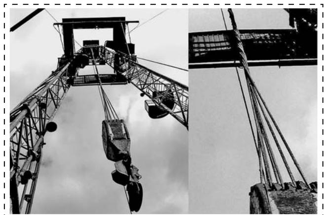
Рис. 1. Закручивание свободно подвешенного талевого блока на буровой установке БУ 2500/160 ЭУ после замены каната
