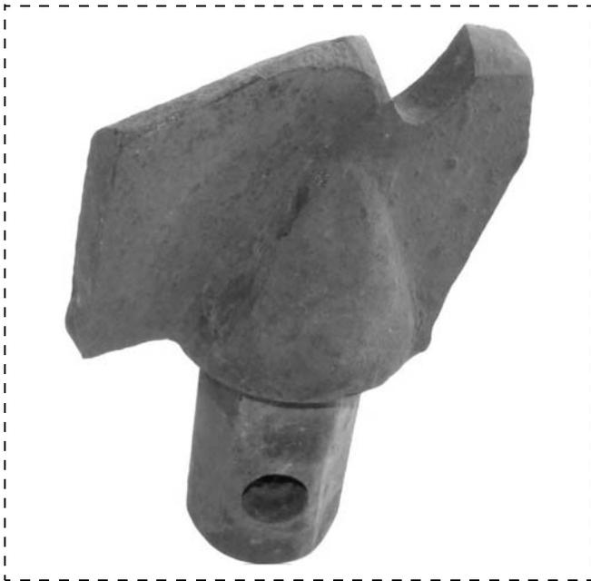
Рис. 4. Долото ДРШ-151, упрочненное нитроцементацией, после наработки 2200 м
