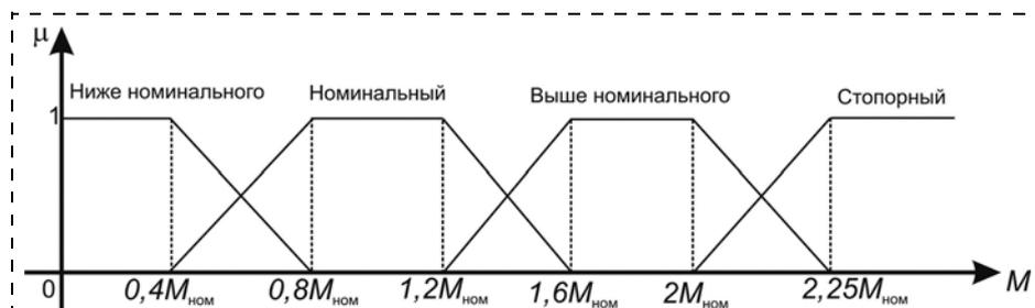
Рис. 5. Теоретические функции принадлежности лингвистической переменной "Нагрузка привода подъема"
