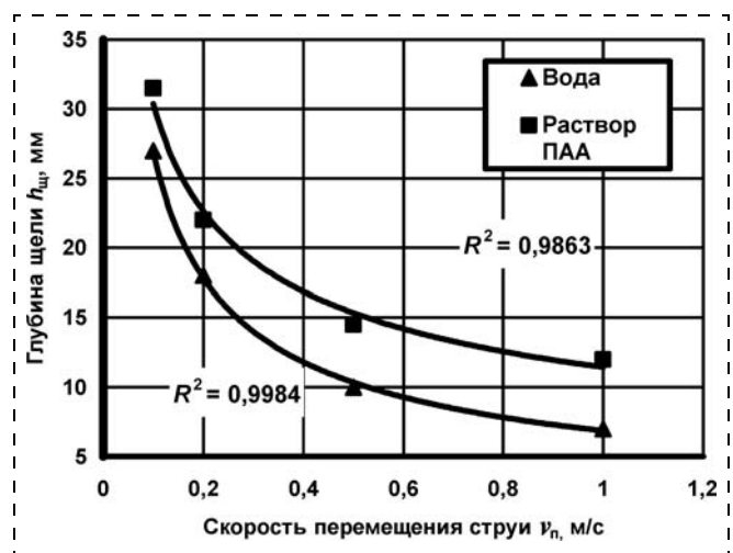
Рис. 4. Влияние скорости перемещения струи на глубину щели, прорезаемой в известняке:
