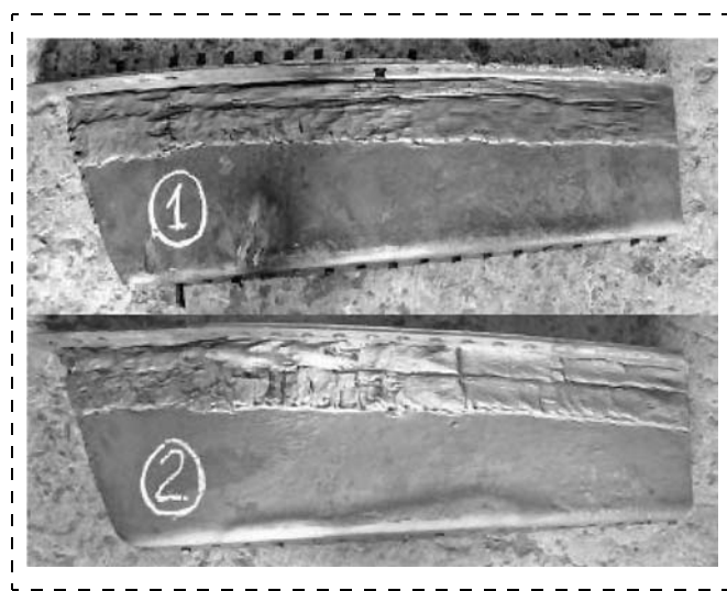
Рис. 5. Лопатки ротора эксгаустера после двойного срока эксплуатации с наплавкой: 1 — ПП-50Х5МГС; 2 — ПП-70Х4М3ГЗФТР
