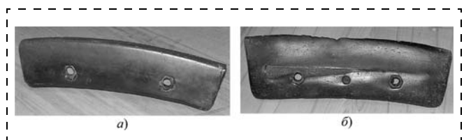
Рис. 4. Характер износа футеровочных элементов с гладкой рабочей поверхностью
