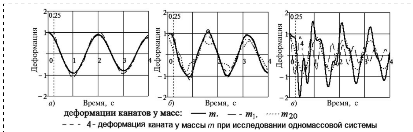
Рис. 6. Характеристики деформаций канатов при различных положениях груженого сосуда
