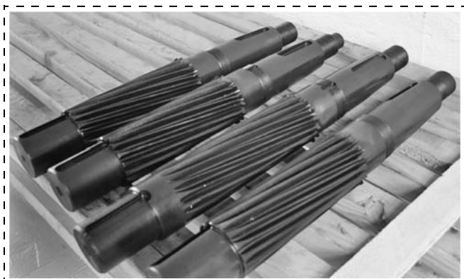
Рис. 4. Валы-шестерни редуктора перемещения бурового станка СБШ-250 после карбонитрации
