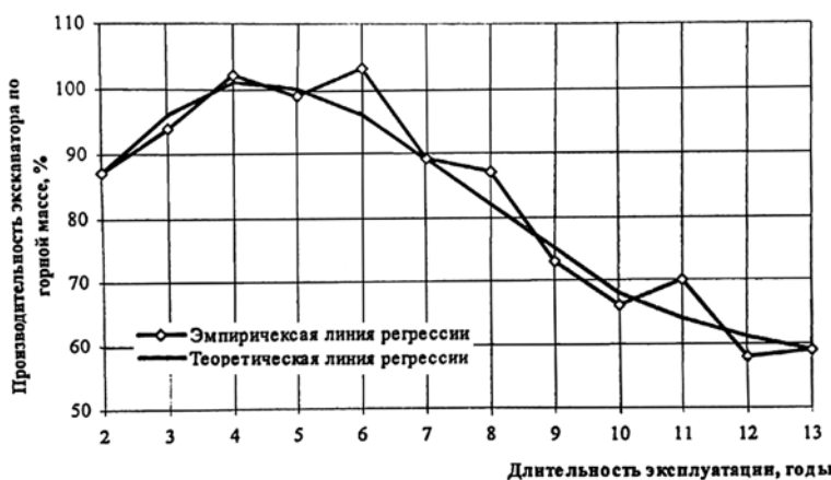
Рис. 1. Зависимость производительности экскаватора ЭКГ-8И от срока его эксплуатации
