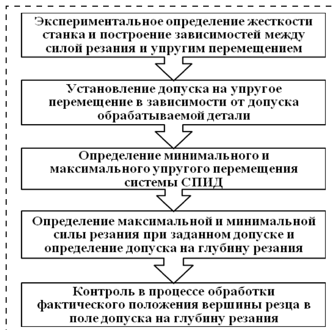
Рис. 4. Алгоритм компенсации упругих перемещений системы СПИД при обработке деталей на универсальных станках с ИКСУ
