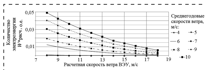
Рис. 6. Зависимость годового приращения количества электроэнергии, вырабатываемого ВЭУ, о. е., от расчетной и среднегодовой скорости ветра при регулировании мощности за счет поворота лопасти около оси маха
