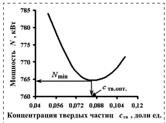
Рис. 3. Зависимость мощности гидротранспорта от концентрации твердых частиц в потоке гидросмеси
