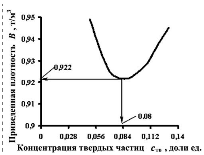
Рис. 2. График изменения приведенной плотности B от концентрации твердых частиц в объеме гидросмеси
