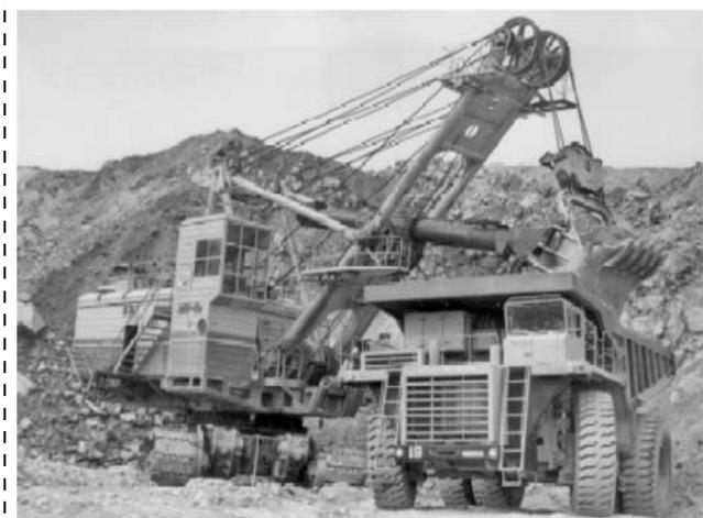
Рис. 1. Карьерный автосамосвал БелАЗ-7521 грузоподъемностью 180 т, изготовленный по технико-экономическому обоснованию ИГД
