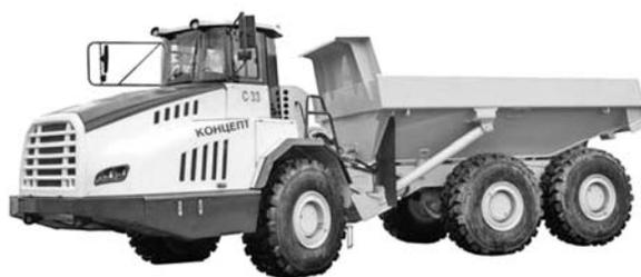
Рис. 3. Шарнирно-сочлененный самосвал С-33 грузоподъемностью 36 т
