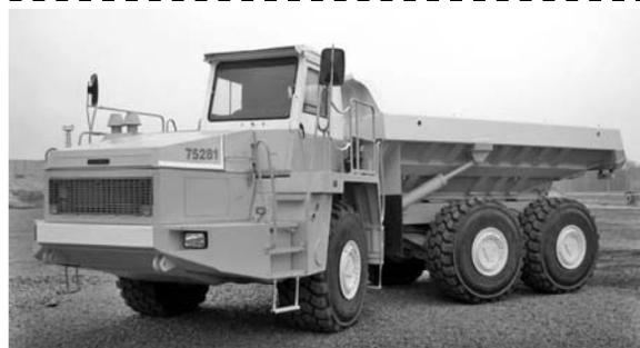
Рис. 2. Шарнирно-сочлененный самосвал БелАЗ-75281 грузоподъемностью 36 т
