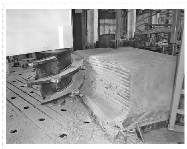
Рис. 9. Фрагмент испытания фрезы с 30-ю резцами ПС-2
