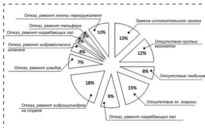
Рис. 7. Диаграмма причин простоев отбойно-погрузочной машины
