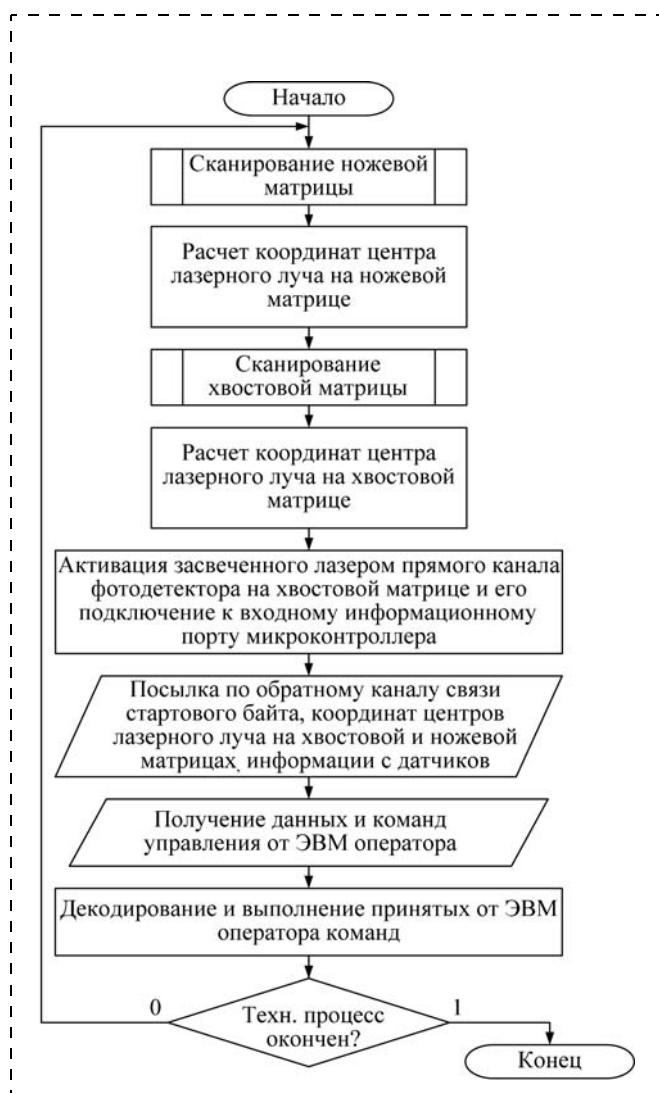
Рис. 3. Схема алгоритма функционирования модуля миницита
