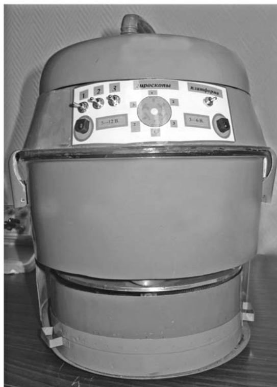
Рис. 1. Конструкция (а) и экспериментальный образец (б) гироскопического измельчителя с загрузкой породы через полый вал вращения рабочей площадки
