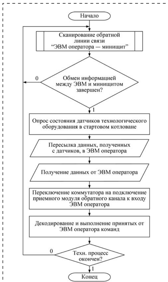
Рис. 4. Схема алгоритма функционирования модуля оператора
